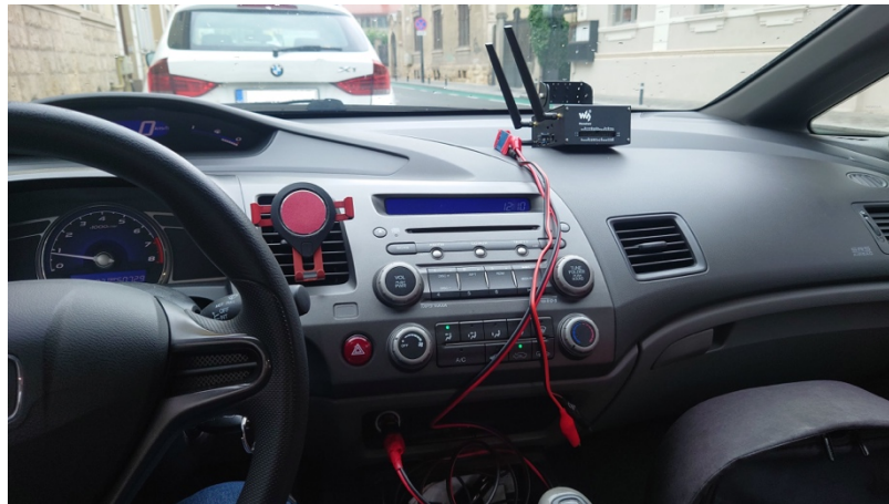
Figura 24. Sistemul de achiziție și procesare instalat în interiorul autovehiculului.
