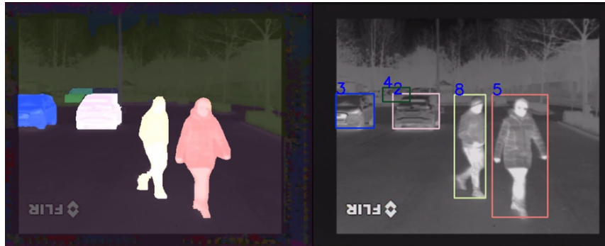
Figura 11. Rezultatele algoritmului folosit. In poza din stânga sunt evidențiate măștile suprapuse peste imaginea de segmentare semantica, iar in poza din dreapta sunt prezentate id-urile trackurilor si chenarele fiecărui obiect.
